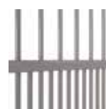
Espacement réduit par rajout de tubes dans le soubassement
